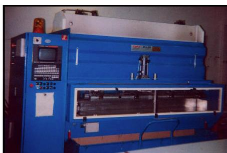
Ces flancs, formés il y a encore quelques années à l'aide de presses hydrauliques manuelles, sont aujourd'hui mis en forme par une **presse hydraulique à commande numérique**. Entièrement automatisée, cette presse possède un magasin dans lequel peuvent être stockés jusqu'à 70 flancs.
